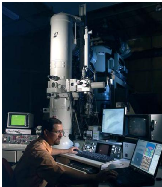
Microscope électronique à transmission (MET) JEOL de 400 kV au CEA/Grenoble. Actuellement équipé d'une caméra CDD haute résolution, cet instrument, avec une résolution inférieure à 0,17 nm, permet de visualiser des défauts dans les structures cristallines.
